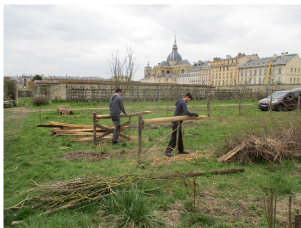
écorçage des piquets sur des chevalets
