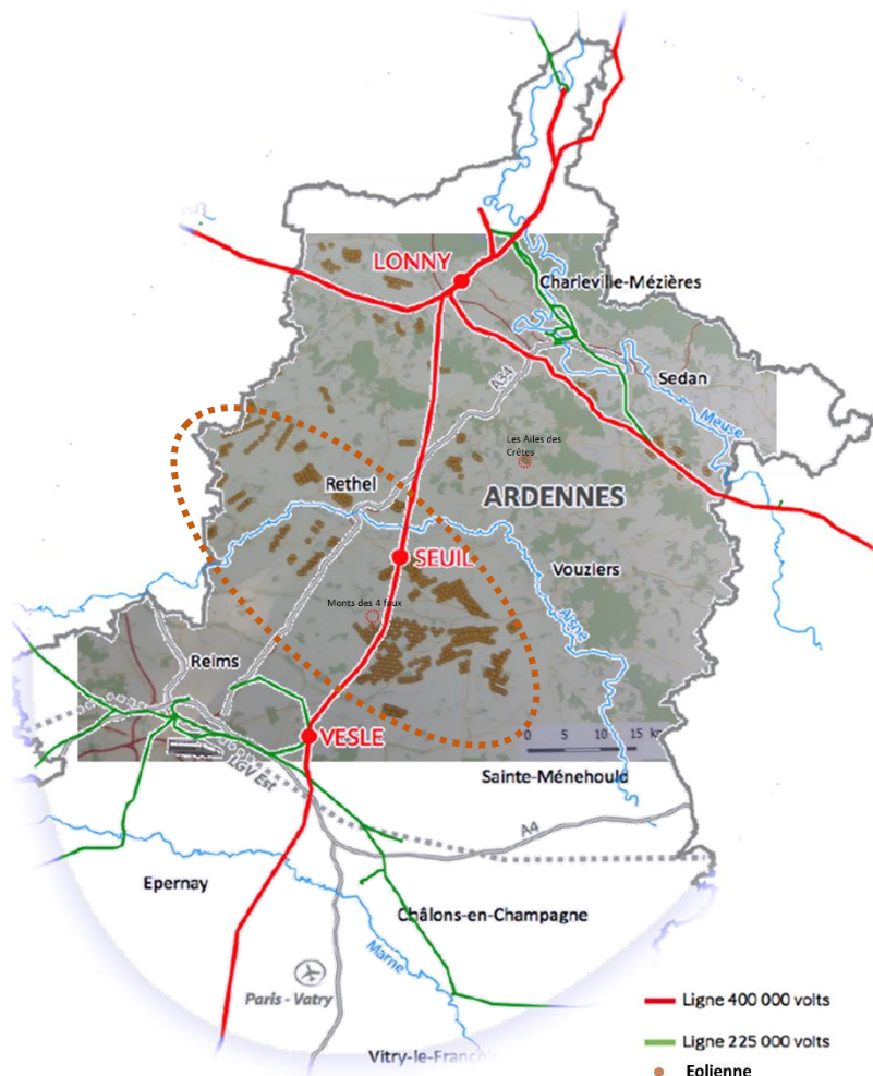
Figure 56. Les implantations éoliennes autour de la LHT Lonny Seuil Vesle notamment au sein du Pays Rethélois et à proximité du poste électrique de Seuil (source : auteurs)
